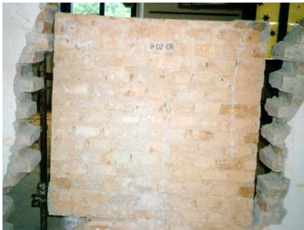
Figura 12. Pannello n. 6 a Belfiore (Foligno) in muratura di mattoni tessuta per soli diatoni con malta di qualità scadente. Per tale pannello si ha IQM = 5 e la prova diagonale ha fornito: \tau_0 = 3,3 \text{ N/cm}^2 .
