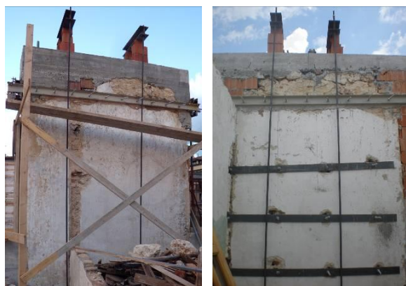
Figura 2. A sinistra, configurazione del pannello oggetto della prova. A destra, configurazione di uno dei setti di contrasto.
