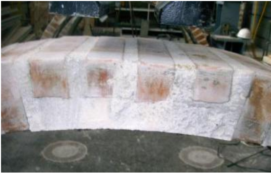
Figura 7. a) Strato di malta regolarizzante; b) Difetti nel supporto.
