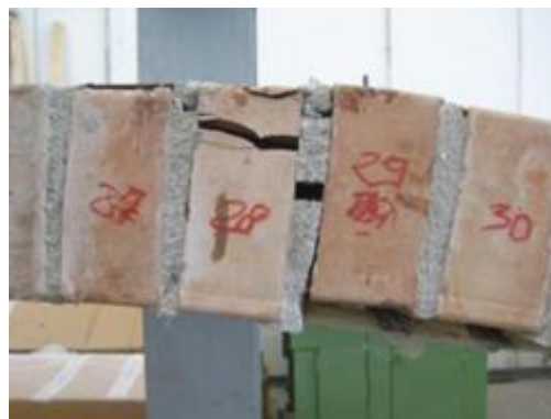
Figura 12. Crisi per schiacciamento della muratura: arco GF.03.
