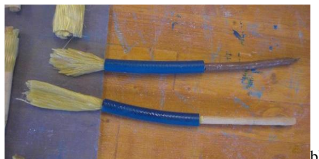
Figura 5. a) Resinatura fibra; b) Essiccamento e rimozione fibra in eccesso.
