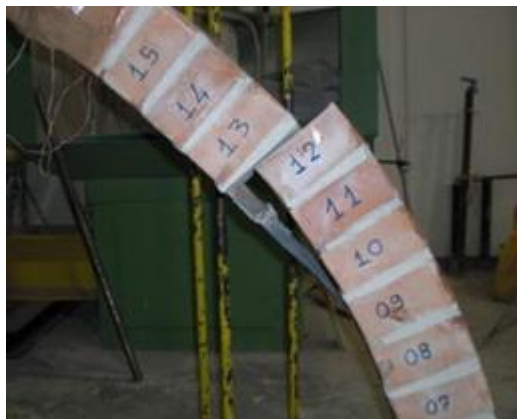
Figura 14. Crisi per scorrimento tra mattone e malta: arco CP.02.
