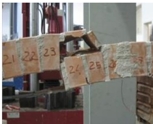
Figura 15. Crisi per schiacciamento della muratura: arco CP.03.
