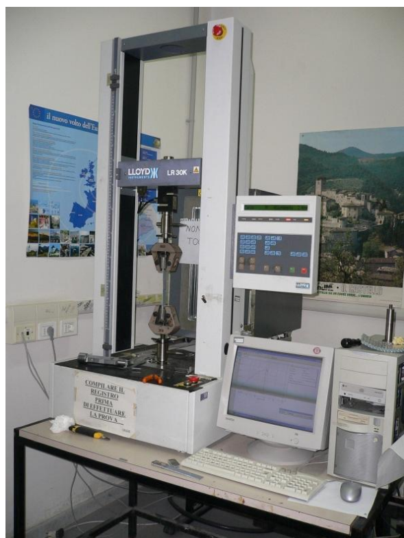
Figura 3. Prove di trazione: dispositivo di prova.
