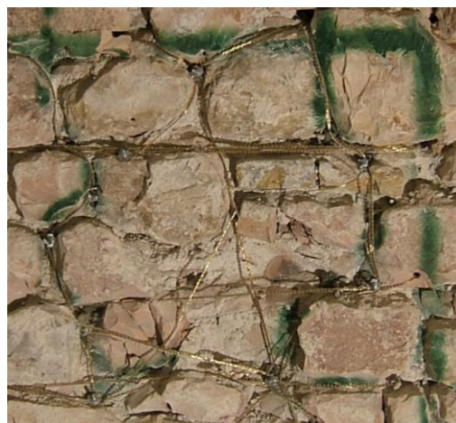
Figura 3: Foto della disposizione del rinforzo nel Reticolatus
